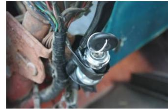
먼저, 전선과 전선으로 연결되어 화재 및 감전의 위험이 도사리던 시동키 부분이 새 부품으로 교체되었고, 임시방편으로 비닐 팩을 뭉쳐서 틀어막아왔던 주유구에 덮개를 장착하여 외관을 단정히 하였다. 이와 더불어 깨어진 후방램프부분은 세련된 원형의 새 램프로 교체되어 기능적으로나 디자인적으로나 한층 더 업그레이드 되었다.
